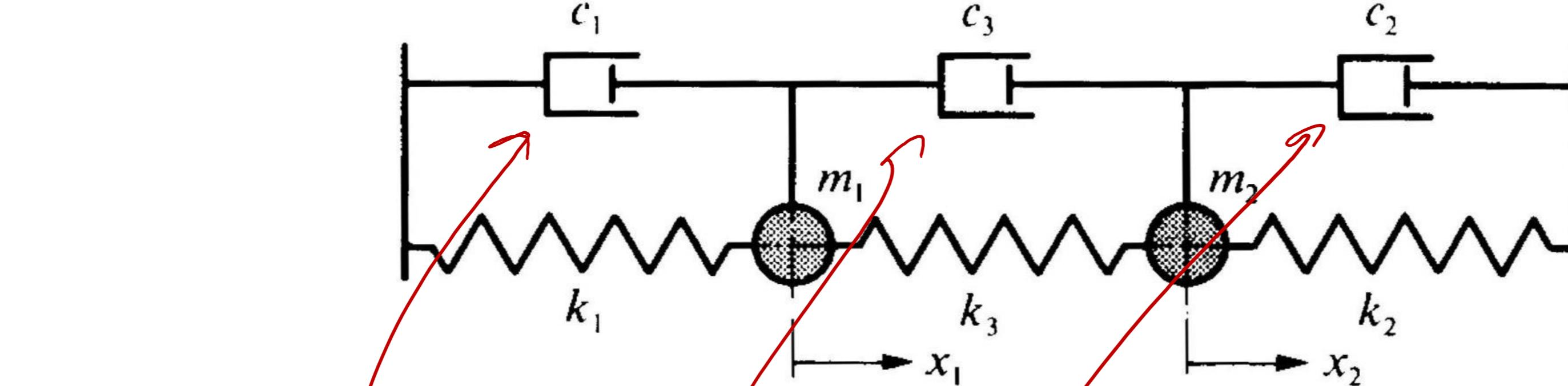
*Fonction de dissipation de Rayleigh du système à deux degrés de liberté*
