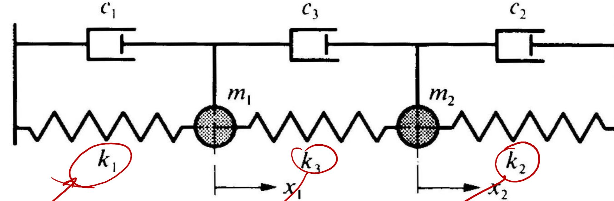
*Energie potentielle du système à deux degrés de liberté*
